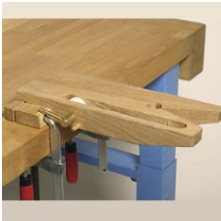
Laubsägetisch mit Exzenterspannvorrichtung und unverlierbaren Rundbügelzwingen. Buche massiv, mit Aufbewahrungss- chlitz. L/B/H 260 x 90 x 35mm
