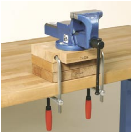
Schraubstockhöhenverstellung zur individuellen Einstellung der Arbeitshöhe. Unterlage aus 40mm starken Buchenholz. Max. Höhe 120mm (3 Unterlagen)
