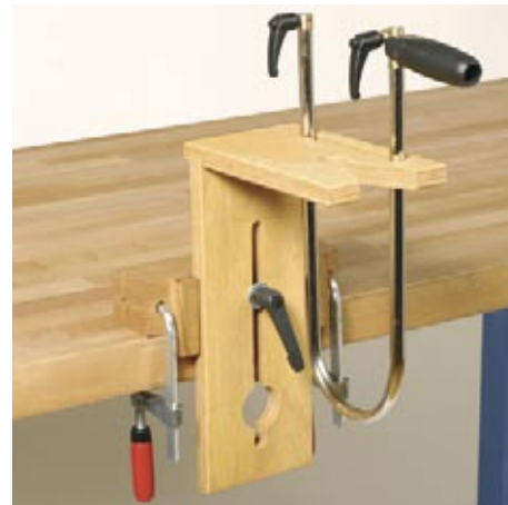
Laubsägetisch höhenverstellbar um 150mm, mit Spann- und Aufbewahrungss- chlitz, Langloch mit Aushängeloch zur Aufbewahrung, mit Rundbügelzwingen, Spannweite 90mm. (ohne Laubsägebogen)
