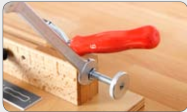
stufenlose Einstellung und Justierung durch Rändelschraube
