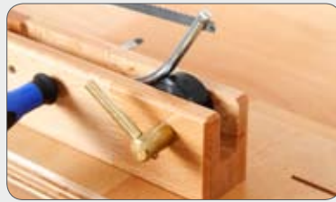
spannen des Sägebogens durch Exzenter
